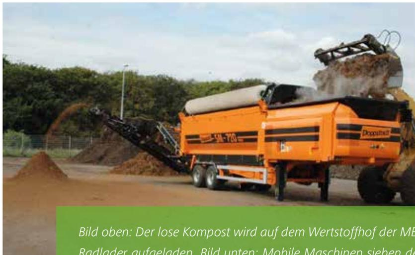
*Bild oben: Der lose Kompost wird auf dem Wertstoffhof der MEBRA mittels Radlader aufgeladen. Bild unten: Mobile Maschinen sichten den Kompost durch und trennen so die letzten Störstoffe ab. Bei größeren Mengen vereinbaren Sie bitte vorher einen Termin unter 0 33 81 323 700.*
